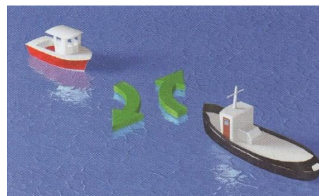
Rysunek 71. Przy kursach przecinających się na wprost, oba statki o napędzie mechanicznym skręcają w prawo
