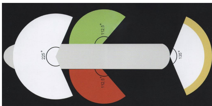
Rysunek 76. Podstawowe oznakowanie nocne statku [Źródło: „Atlas żeglarski” M.Klawinski]
