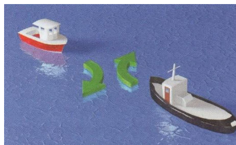
Rysunek 72. Przy kursach przecinających się na wprost, oba statki o napędzie mechanicznym skręcają w prawo
