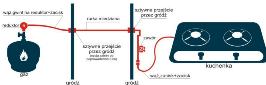
Rysunek 20. Instalacja gazowa [Źródło: Opracowanie Błękitny Piotruś]
