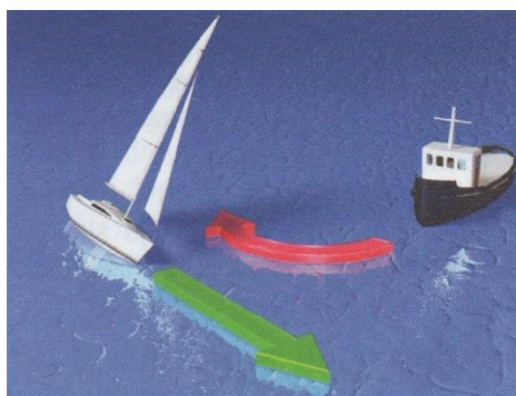
Rysunek 75. Statek o napędzie mechanicznym ustępuje statkowi żaglowemu
