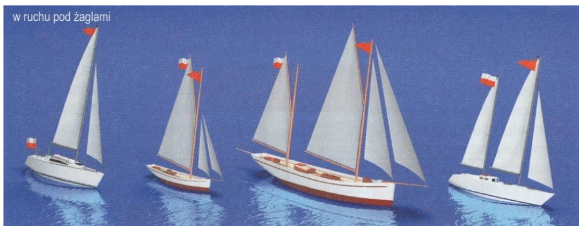
Rysunek 155. Noszenie bandery, flagi i proporca na jachtach jednomasztowych i dwumasztowych w ruchu pod żaglami [Źródło: „Żeglarz jachtowy i jachtowy sternik morski” A. Kolaszewski, P. Świdwiński]
