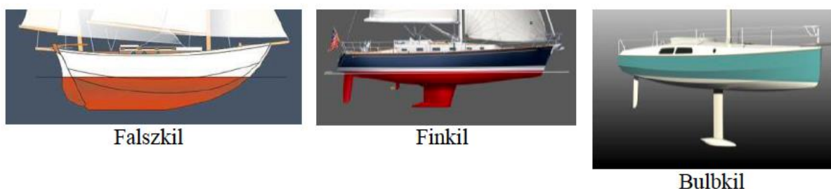
Rysunek 5. Rodzaje balastu [Źródło: „Atlas żeglarski” M.Klawinski]
