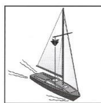
Rysunek 92. Statek żaglowy korzystający z napędu mechanicznego, podczas żeglugi pod żaglami
